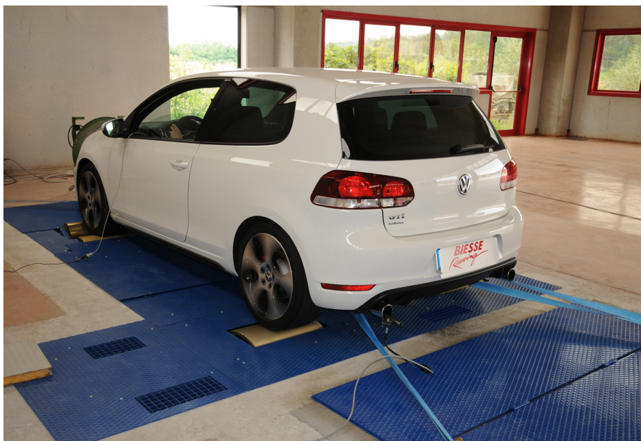
La Golf 6 GTI durante i test sul banco Rotronics (la sala prova è in corso di allestimento)
